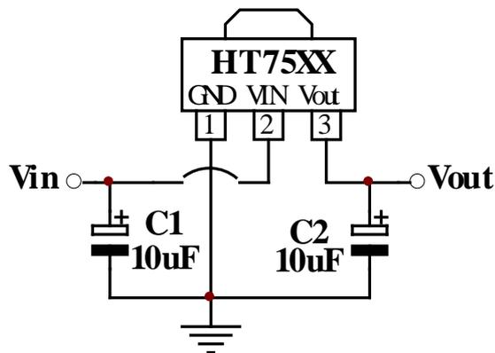
**2、高输出电流稳压电路**
