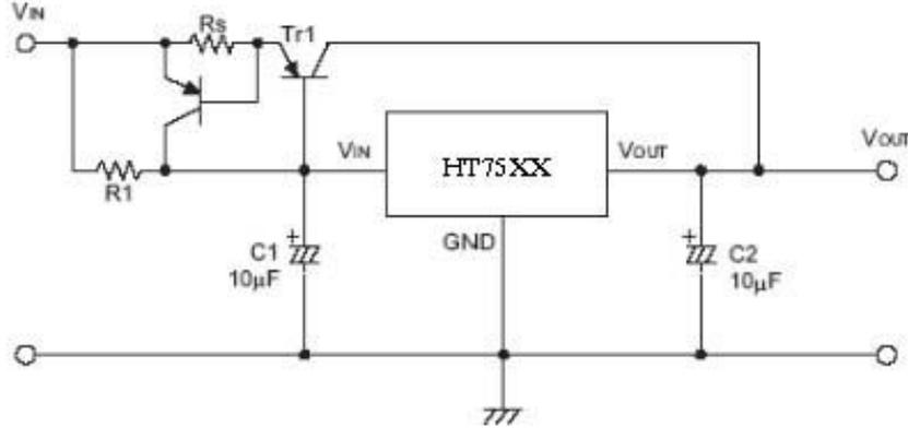
4、 提高输出电压电路(1)
